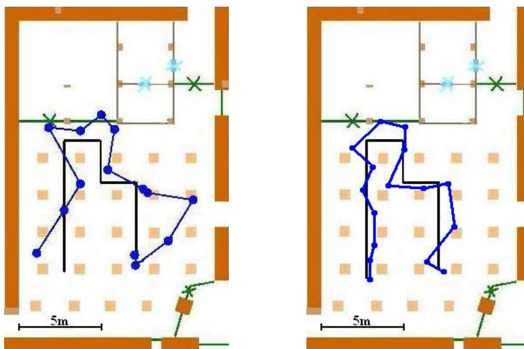
Figura 2. Localizzazione senza (sinistra) e con (destra) rilevamento dei vincoli strutturali dell'edificio. La traiettoria effettivamente seguita è rappresentata da una linea spessa nera, quella ricostruita da una linea più sottile, blu.
